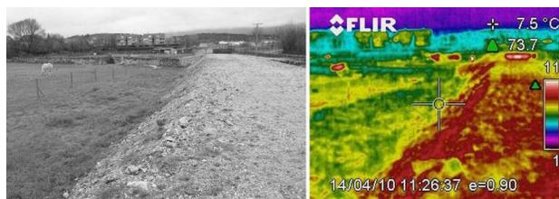
Figura 8. Par fotografía-termografía de nuevas canalizaciones cubiertas por zorra y elementos adicionales como ejemplo del comportamiento optoelectrónico de diversos materiales según las condiciones ambientales. Tomada por los autores.
