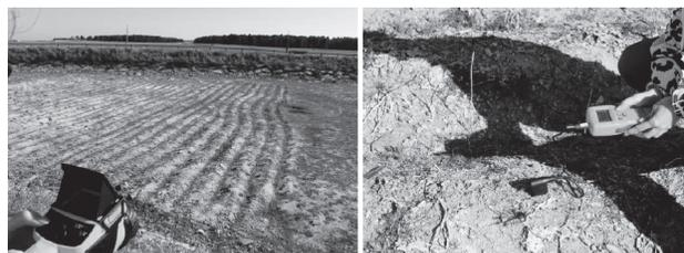
Figuras 9 a) y b). Cámara termográfica *Therma-Cam E2* y determinación directa de la temperatura y humedad en superficie para validar la firma térmica. Fotografías tomadas por los autores
